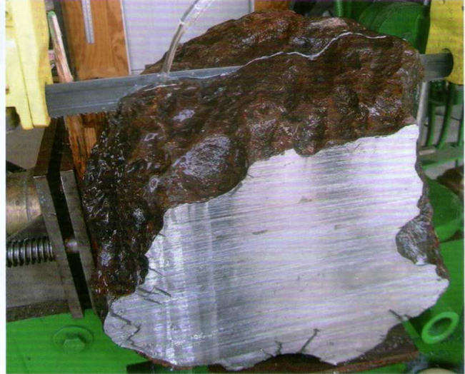
Figura 2. Proceso de corte del meteorito de Zaragoza. A la izquierda, antes de iniciarse el proceso, puede verse la diferencia de aspecto entre la zona expuesta al exterior, en la parte alta, y la que permanecía enterrada. A la derecha, tras el primer corte, se aprecia su aspecto metálico. (Fotos: Michel Farmer).
